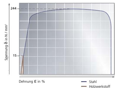
Das Spannungs-Dehnungs-Diagramm beschreibt, wie leicht ein Werkstoff verformbar ist und wann dieser Werkstoff versagt, also z.B. bricht. Man sieht, dass Stahl im Gegensatz zu Holz nur sehr schwer zu verformen ist, auch extrem hohen Kräften standhält und selbst im kritischen Bereich durch sein plastisches Verhalten noch einen Sicherheits-Spielraum bietet.
