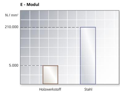
Das „Elastizitäts-Modul“ bezeichnet das Verhältnis der notwendigen Kraft zu einer dadurch verursachten Verformung. Heißt also: Wie viel Kraft muss ich aufwenden, um einen Werkstoff zu dehnen? Das Diagramm zeigt, dass Stahl als Werkstoff in Sachen Stabilität und Elastizität unschlagbar ist.
